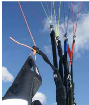
オーソドックスな4本ライザー。翼端折用のAライザーを装備。
