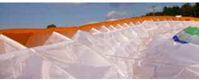
マイラーを使用していないリーディングエッジ。縦方向に細いナイロンパテンが縫いこんであり、軽く完璧なフォルムを実現。Airfoil Stabilizing Systemと呼ばれる。
