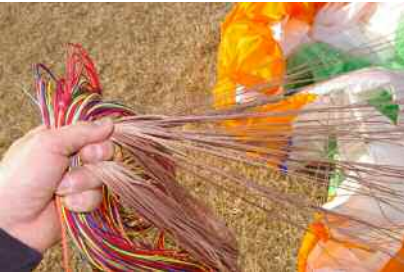
ポトムラインはUVコート済みの0.8~0.9mmコンベライン。ラインボリュームは限りなく少ない。
