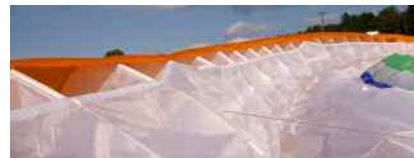
マイラーを使用していないリーディングエッジ。縦方向に細いナイロンパテンが縫いこんであり、軽く完璧なフォルムを実現。Airfoil Stabilizing Systemと呼ばれる。
