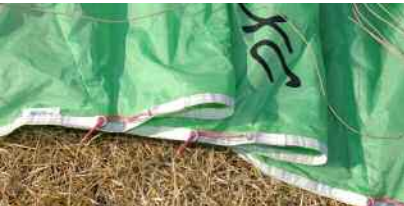
BTSシステムと呼ばれるブレークラインの末端処理。横方向にシフトさせリングを介している。トレーリングエッジは絞るように引かれるため、最小限のテンションで効率的なブレーク操作が可能。
