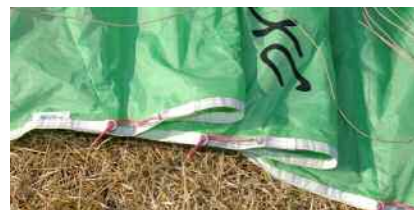
BTSシステムと呼ばれるブレークラインの末端処理。横方向にシフトさせリングを介している。トレーリングエッジは絞るように引かれるため、最小限のテンションで効率的なブレーク操作が可能。
