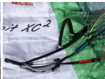
ラインごとにテープで色分けされたライザーは2A+1A/4B/3Cの3本ライザーを採用。
