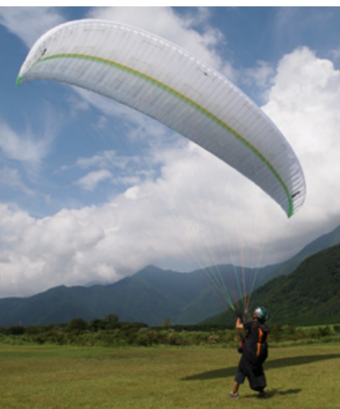
3ライナーだが、CラインはDラインに分歧し2ヶ所で接続。トレーリングエッジにはハーフリップ構造を採用しエアフォイル安定させている。
