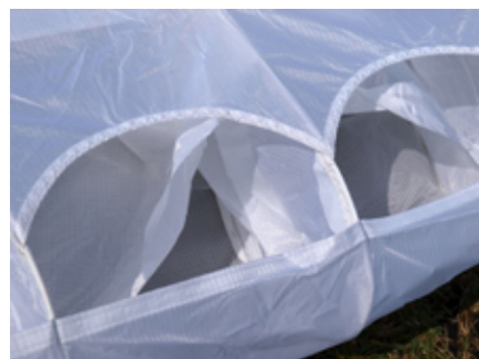
ラウンド型のインテークとリブに沿ってナイロンロッドを縫い込んだマイラーレス構造を組み合わせている。
