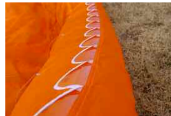
半円形のインテーク。リーディングエッジはAirfoil Stabilising System 2と呼ばれるナイロンパテン入り。マイラーフィルムは使われていない。
