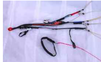
新3本ライザーは独特の構造、ABラインの翼端側がアラミド製可動ラインに連結されている。Cライザー後ろにトリマーが見える。
