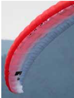
上左:ダブル3Dパネルは上面前縁部分を理想的なカーブに仕上げ、パフォーマンス向上に一役買っている。上右:リーディングエッジはナイロンロッドとマイラーを組み合わせたASS2。キボはマイラーの面積を小さくして軽量化に貢献。控えめなシャークノーズによるFSSと共に、トップスピードでの安定性を向上した。下半円形のエアインタークは、翼端2セルをクローズ。クォーターリップと絞り込むように引き下げるBTS2が、パフォーマンス向上と快適な操作フィーリングに寄与している。
