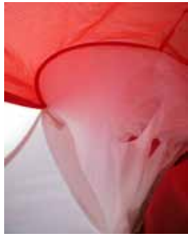
上左:ダブル3Dパネルは上面前縁部分を理想的なカーブに仕上げ、パフォーマンス向上に一役買っている。上右:リーディングエッジはナイロンロッドとマイラーを組み合わせたASS2。キボはマイラーの面積を小さくして軽量化に貢献。控えめなシャークノーズによるFSSと共に、トップスピードでの安定性を向上した。下半円形のエアインタークは、翼端2セルをクローズ。クォーターリップと絞り込むように引き下げるBTS2が、パフォーマンス向上と快適な操作フィーリングに寄与している。
