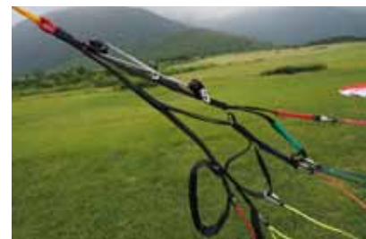
新しい設定のライザーは、2A+1A/4B+スタビ/1C+2C'と凝った構造の変則5本ライザーを採用。
